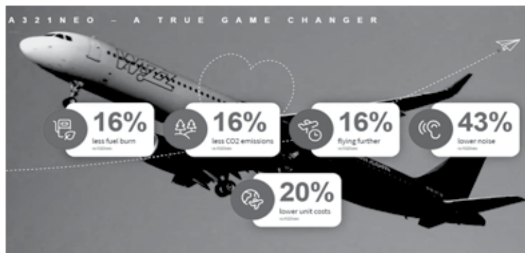
Rysunek 4. Cechy charakterystyczne samolotu A320 neo Family w porównaniu z A320 ceo
