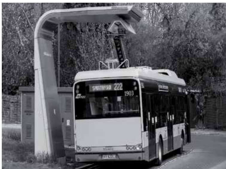
Rysunek 3. Autobus elektryczny podczas ładowania akumulatorów w Warszawie
