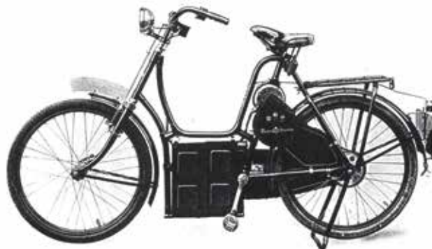
Rysunek 6. Elektryczny rower na licencji Philipsa wyprodukowany przez holenderską firmę Burgers
